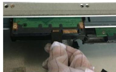
3. Подключите один конец сигнального кабеля к HDD.
