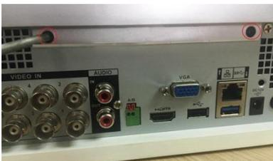
1. Вывинтите винты и снимите крышку.
