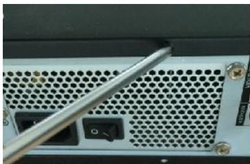
1. Ослабьте винты на панели и снимите крышку.
