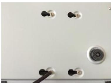
4. Переверните Устройство дном вверх. Вставьте винты HDD в отверстия дна и завинтите их.
