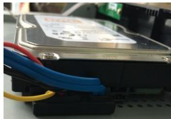
5. Соедините HDD с системной платой силовым и сигнальным кабелями.
