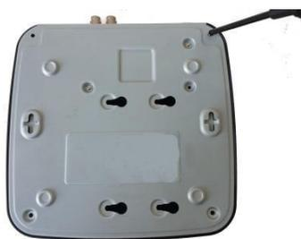
1. Вывинтите винты и снимите крышку.
