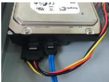
5. Соедините HDD с системной платой силовым и сигнальным кабелями.
