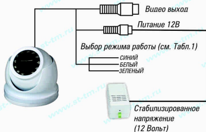
Рис.1 Схема подключения
