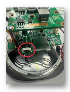
Зажать кнопку на 30 секунд и дождаться перезагрузки устройства. После устройство будет сброшено до заводских настроек.
