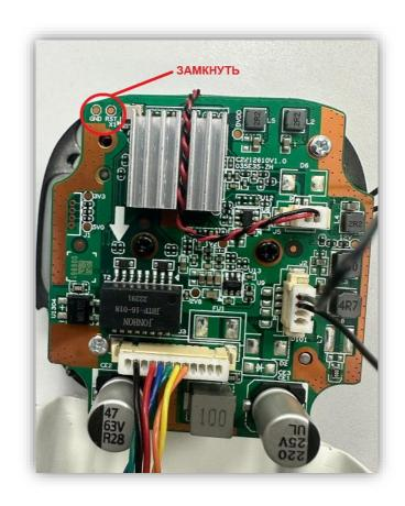
Так же, как и кнопку зажать на 30 секунд и дождаться перезагрузки устройства. После устройство будет сброшено до заводских настроек. Пароль по умолчанию 12345 или задается при включении.
