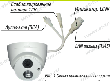
Рис. 1 Схема подключения видеокамеры
